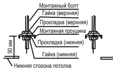
Установите подвесной болт в Т-образный паз инструмента для подвески. Навесьте внутренний блок и с помощью уровня убедитесь в том, что он расположен горизонтально.
