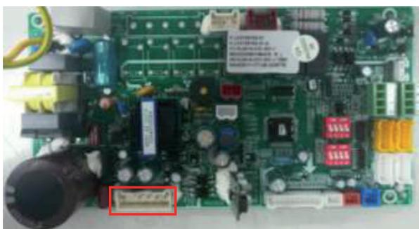
**Метод устранения:** проверьте разъем электродвигателя внутреннего блока и гнезда (CN3) и (CN4). Если они ослаблены или не подключены, присоедините правильно.
