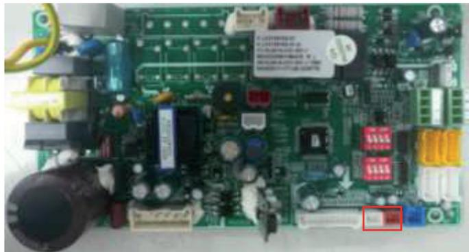
**Метод устранения:** проверьте разъемы датчика и гнезда (CN6, CN6-1, CN6-2). Если они ослаблены или не подключены, подключите правильно.
