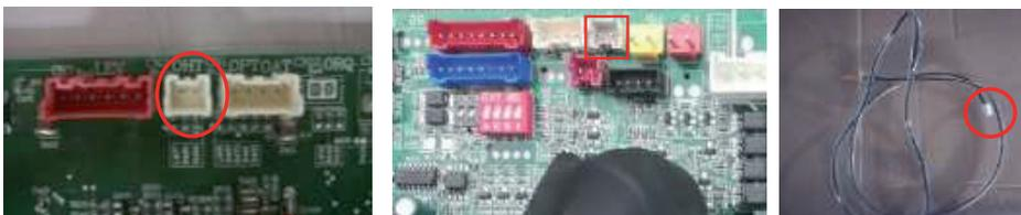
**Метод устранения:** проверьте разъем датчика и гнездо. Если они ослаблены или не подключены, подключите правильно.
