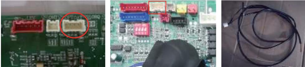
**Метод устранения:** проверьте разъем датчика и гнездо. Если они ослаблены или не подключены, подключите правильно.
